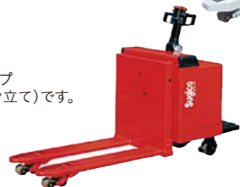
2LR1タイプ 杉国工業 乗車して長距離搬送ができるライダータイプ
