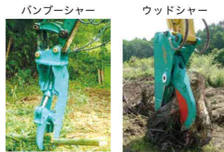
バンブーシャー 切りにくい竹も楽々切断。街路樹の枝剪定も一刀両断。 ウッドシャー 丸太や抜根を楽々切断。
